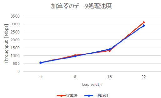
図2 開発手法と従来法（ハードウェア記述言語による設計）を用いて設計した加算器のデータ処理速度の比較
