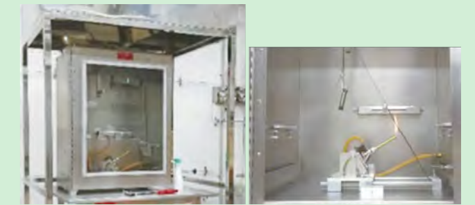
航空機の内装品(シート素材、電線、配線素材)などを対象として、難燃性を証明するための燃焼試験です。
