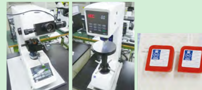
ASTM規格で校正された硬さ試験機。ASTM標準試験片を備え、基準に準拠した金属材料の測定が可能です。
