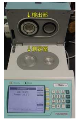
図 1 電気抵抗式水分活性測定装置
