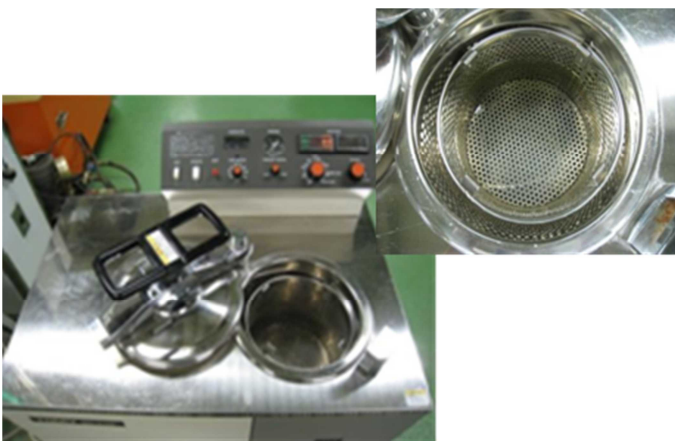
図 2 レトルト殺菌試験機
