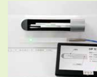
MPセンサの拡大モデル(100倍) MPセンサの構造をわかりやすく説明した内部模型を製作。
