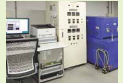
熱電対自動校正装置 精度の高い温度の校正試験を実施し、製品の性能を証明。
