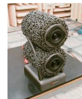
図4 無響室で音響特性を測定
