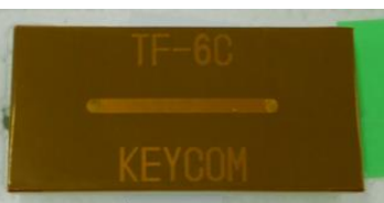
図2 マイクロスト リップラインジグ外観
