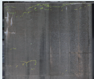
FOCUSの測定例(クラックの抽出画像) クラック幅・長さの検知精度は最小0.1mmで、最大70mの距離から撮影・検知が可能。NETIS登録：KT-130046-V NEDO*から受託開発した「空港滑走路クラック調査システム」にもこの技術が用いられた。
