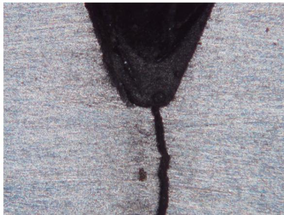
図1 鋼材の疲労き裂
