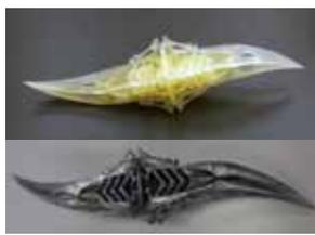
インクジェット式3次元造形装置による試作品(上)と製品(下)の一例
