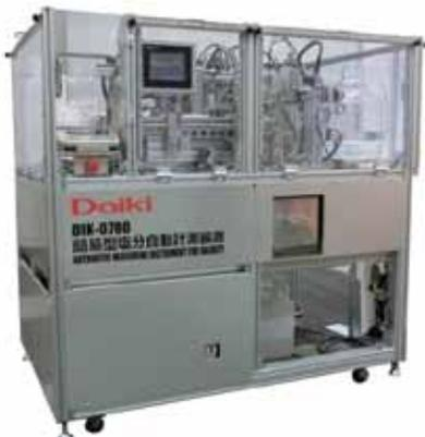
簡易型塩分自動計測装置
