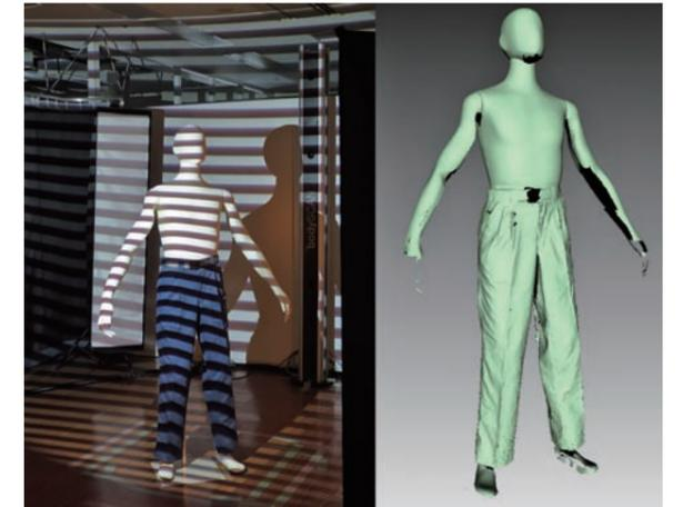
図3 パターン投影式装置によるマネキンの測定例
