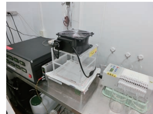
図4 発汗ホットプレート試験機 試験する生地は、着用時と同様の伸縮率を実現するために、伸ばした状態で発汗ホットプレート試験機に設置されます。また、ホットプレート上部に設置された送風機が安定した気流環境を作ります。
