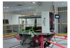
プラザ内の施設での テスト写真 耐久性試験の一つである「ドラム型走行耐久性試験」の様子。
