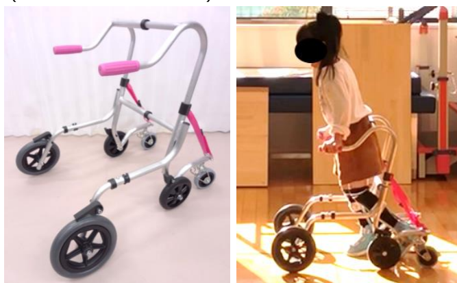
開発した6輪歩行器と実証試験の様子
