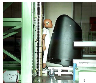
図2 三歳児ダミーを用いた衝突安全性試験
