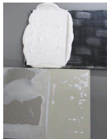
図2 誘電加熱により接合後、引張せん断試験を行ったあらかじめ接着材を熱プレスしたアルマイト処理アルミ板とGF-PP試験片
