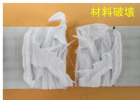
図1 引張せん断試験により材料破壊を起こしたGF-PP試験片
