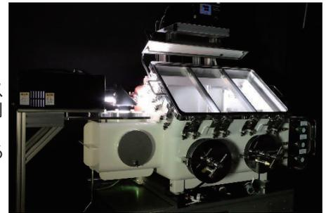
PVK太陽電池測定用環境制御試験槽
