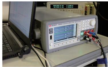
Keysight SMUと内製プログラムによる最大出力追尾 (MPPT測定) 装置
