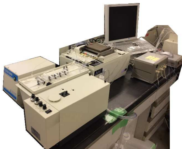
写真 ほう素常時連続モニタリング装置
