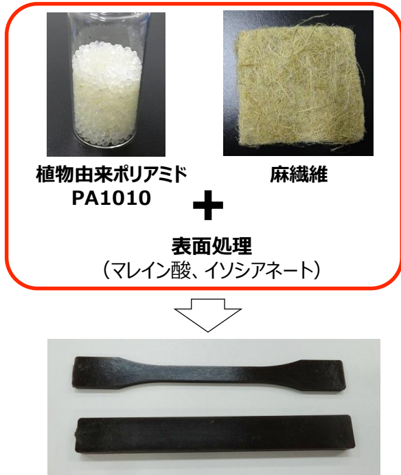
図1 作製したポリアミド複合材料の試験片
