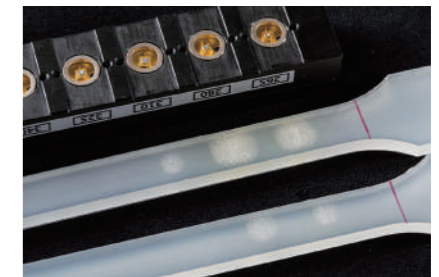
試験片 照射された紫外線の波長により、試験体の劣化が異なることがわかる(添加剤の有無の違い)。
