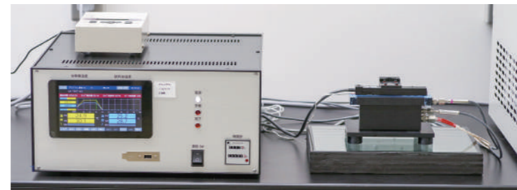
装置全体 「UV-EYES」は、光源部(上)と温度制御機構が組み込まれた試料台(下)、さらにそれらの制御装置から構成されている。
