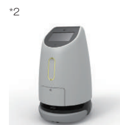
*2 「新型リブラ」の外観。サービスロボットの製品安全規格ISO 13482およびJIS B 8446-1に、公設試験研究機関の開発した自律移動案内ロボットでは初めての適合の証明を受けた。
