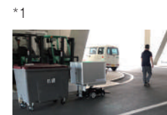
*1 作業者に自動追従する運搬ロボットの、実証実験の様子。作業者の負担軽減や、運搬量の増加が期待される。
