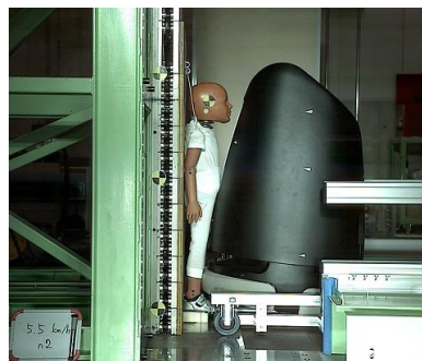
3歳児ダミーを用いた衝突安全性試験
