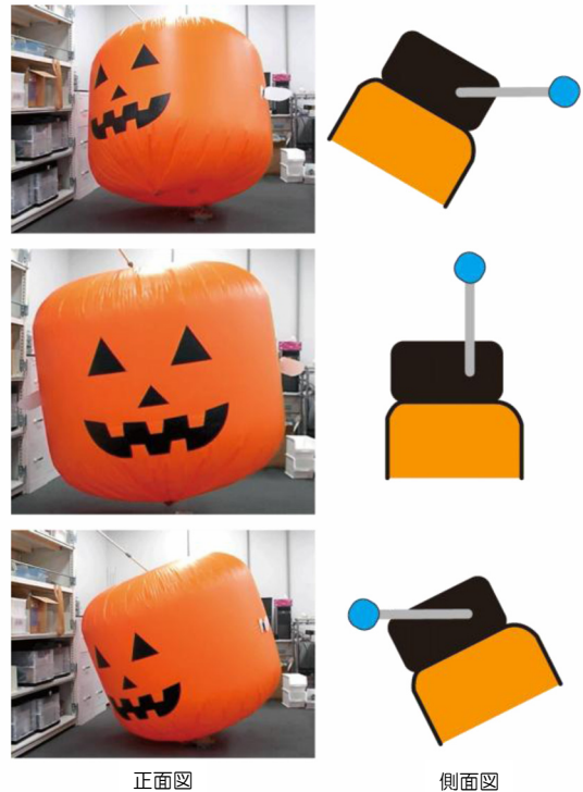
図10. 重心移動機構動作過程
