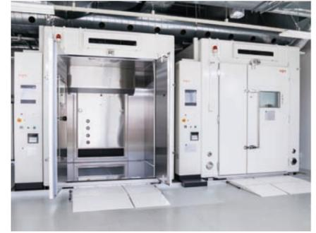
恒温恒湿室を1台→2台に増設。予約待ちを緩和するとともに、「大型の試験品を、低温状態から一気に高温状態へ」といった試験も可能になる。
