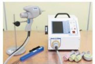
※EMC試験とは：電子機器が発する電磁妨害波が他の機器の通信を妨害しないか、電子機器が電磁妨害を受けても誤動作しないかなど、EMC (electromagnetic compatibility: 電磁両立性) について評価する試験です。
