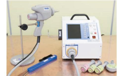
写真4 静電気放電試験
