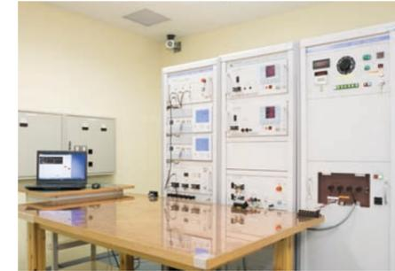
写真3 過渡電気伝導 (サージ) 試験
