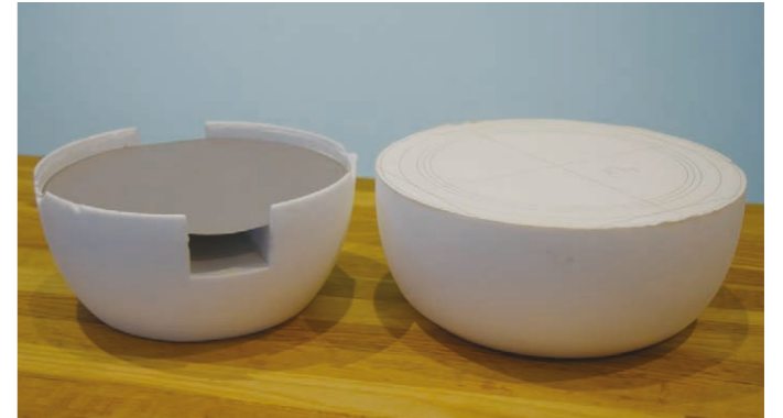
鍋の形状は発泡材を削って検討した。3Dプリンターで出力した注ぎ口をはめ込むため、側面に穴を開けている。
