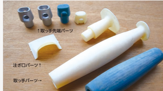
3Dプリンターで出力したパーツ。注ぎ口の三次曲面や、取っ手先端の複雑な形状を検証するため、3Dプリンターを活用した。
