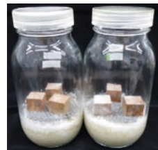
写真1 木材腐朽培養の様子 (20×20×20 mmの木片)
