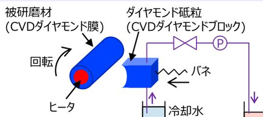
図2 共擦り研磨の実験装置構成
