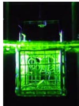
図3 水面浮上油の挙動の可視化
