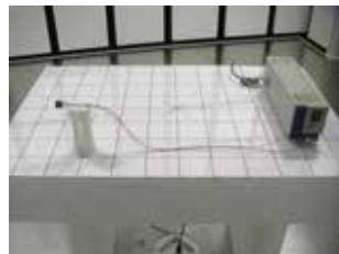
図3：超音波センサの放射エミッション測定
