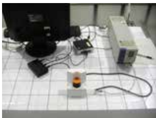
図2：レーザーレンジセンサの電源効率の評価
