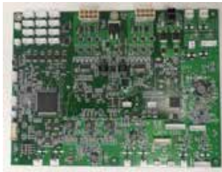
図4：T型ロボットベースの新しい制御基板（面積 200×150 mm）
