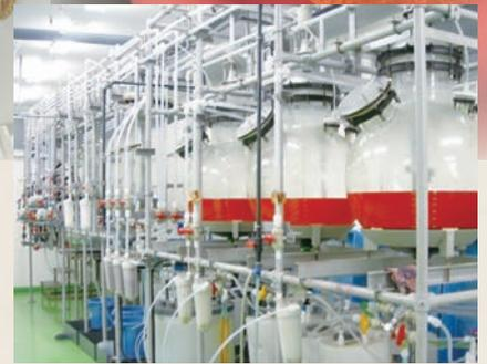
東京工場での溶媒抽出の様子。通常、金の精製には電解法が用いられるが、溶媒抽出法を採用することで全体の工程を3、4日間短縮することができた。
