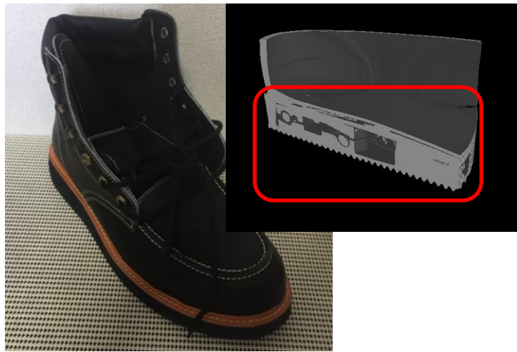
図2 IoT安全靴の試作： 自己発電素子をかかと部分に組込んだ本底を試作しました（右上図 X線CT撮影結果 赤枠）。そして、この本底を用いたIoT安全靴を試作しました（左図）。この電力でつま先部分のLEDを光らせたり、取得したGPSの測位データをBluetooth送信したりすることができます。これにより、暗所での作業や危険作業時の自己位置認識、安全確保が可能となると同時に、従来必要であった電池交換に伴うメンテナンスコストが削減されます。
