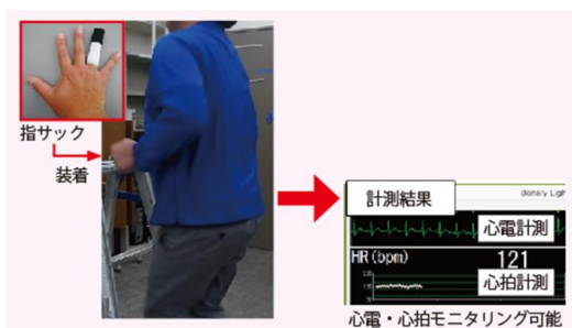
図.ウェア着用時の昇降連続動作による検証
