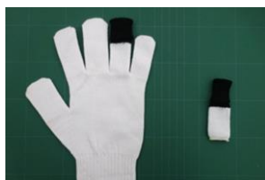
図.導電繊維(濃色部)を編み込んだ手袋と指サック
