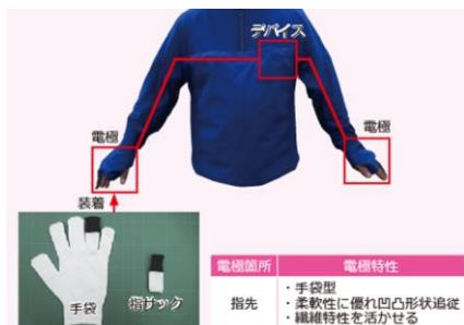
図.信号解析デバイスを内蔵した試作ウェア
